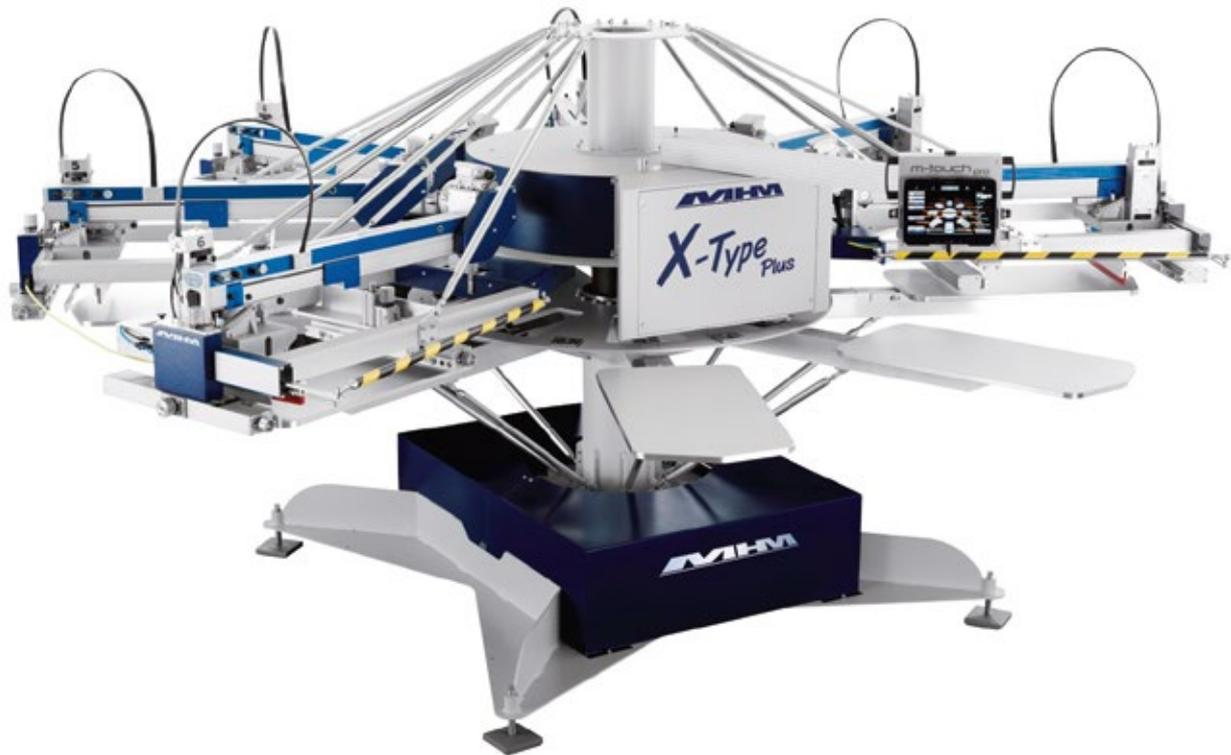
El indizador accionado por CA proporciona velocidades de producción súper rápidas (en cualquier dirección), mientras que los cabezales de impresión con variador de frecuencia CA producen suaves y consistentes carreras de impresión en todas las velocidades y presiones para obtener una calidad de imagen superior y una repetibilidad precisa.
